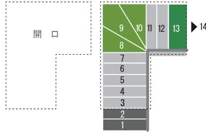
I、L、およびU型の下構成図一覧に示されている寸法には、壁からのクリアランスの最小寸法として2 cmが含まれています。
